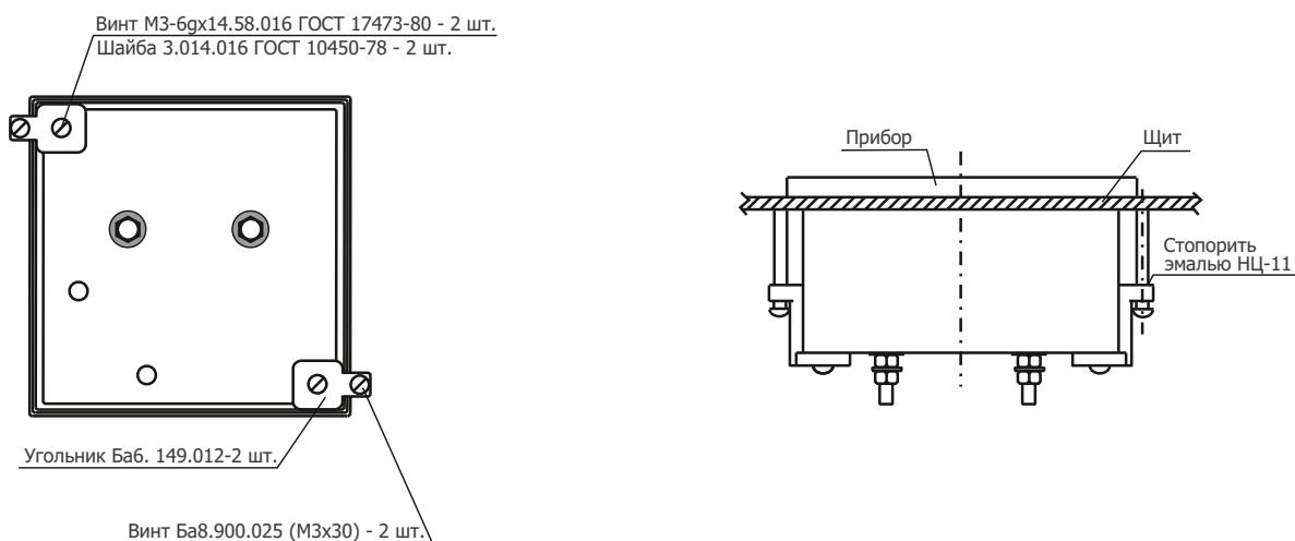
Схема 3. Схема крепления приборов ЭА72, ЭВ72, ЭА96, ЭВ96, ЭА120У, ЭВ120У.
