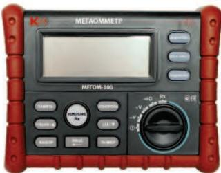
Цифровые мегаомметры МЕГОМ-100(300) предназначены для измерения сопротивления изоляции электрических цепей, не находящихся под напряжением, напряжения постоянного и переменного тока, сопротивления соединений заземлителей с заземляемыми элементами, низковольтного измерения активного сопротивления и контроля целостности электрических цепей.
