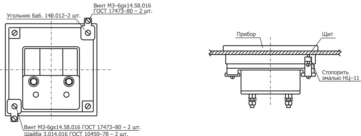
Схема 2. Способ крепления приборов ЭА120Ц, ЭВ120Ц.
